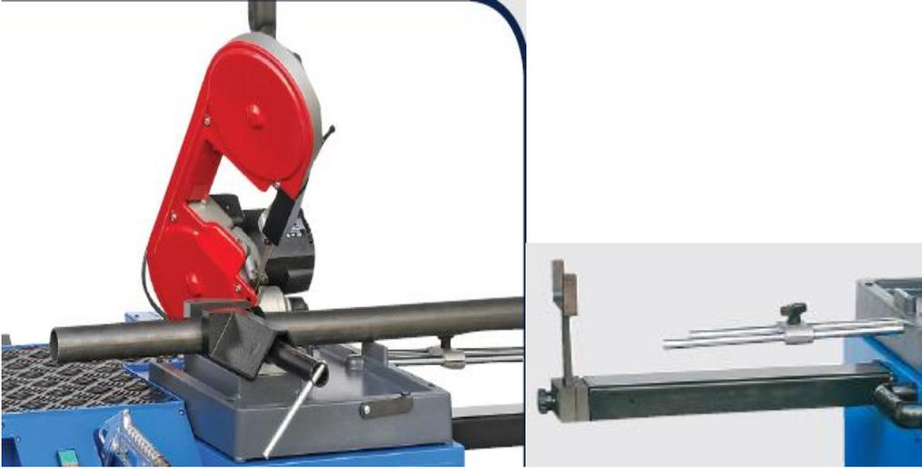
机器上，带有两个支撑架，对于长的钢管，两边可以架住。带有台虎钳夹紧，两个支撑点与台虎钳配合，只要钢管与三个支撑点都接触到，钢管平整度误差就在 0.5 度之内。非常平整。
