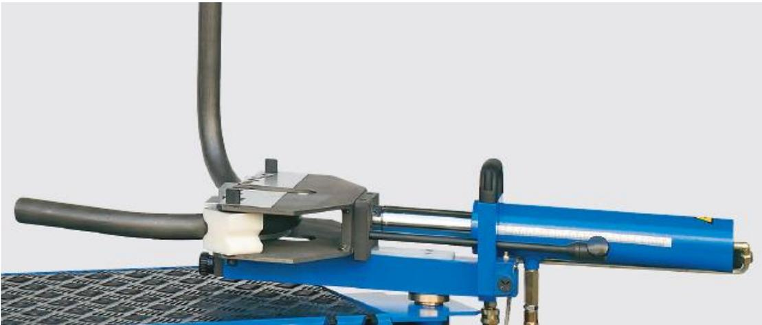
冷弯，弯管过程简单，不需要填充，管子不会变形，划痕也小，弯曲过程中，角度清晰可见，随时根据现场需要，弯曲不同角度，可以弯空间三维角度。有行程定位开关，对于弯一批角度一样的管子更方便。弯管半径为 2.5-3 倍钢管直径。
