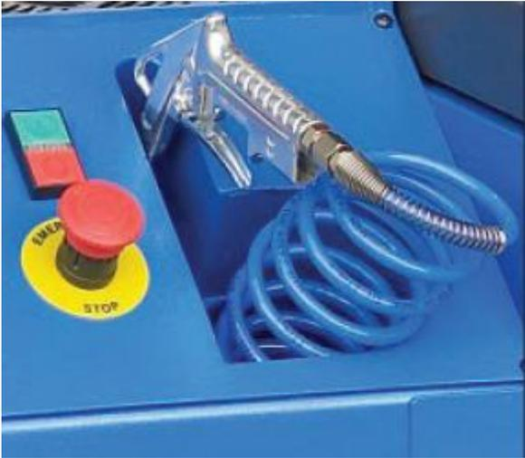
机器上带有一个空压机，可以清理钢管去毛刺之后的铁屑，也可以清理机器以及工作场所的铁屑灰尘，如果需要，空压机可以独立拿出。
